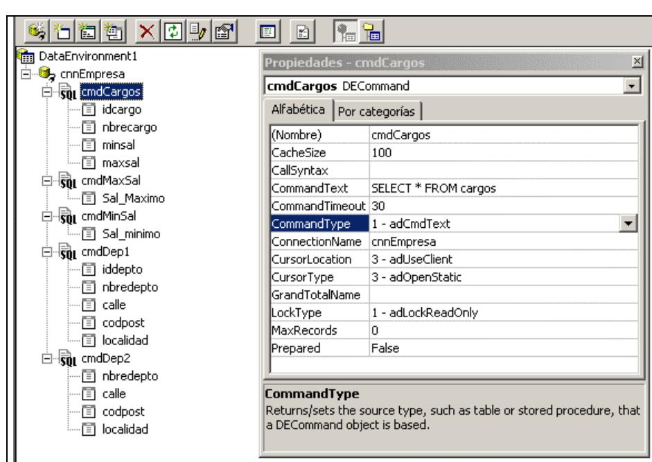
que el diseño de las conexiones y operaciones sobre la base de datos es independiente también del diseño de los formularios que hacen a la interfaz con el usuario. Por ejemplo, el DataEnvironment1, al ser un objeto contenedor podría alojar no sólo la conexión sobre la base de datos Empresa sino también sobre otra base de datos. A su vez cada conexión contiene varios comandos, como en el ejemplo, sobre una o más tablas, vistas, etc.
